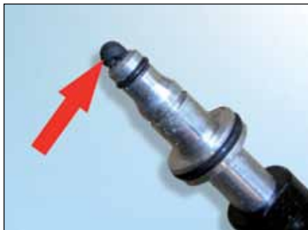
Kuva 4: Ellei vanhaa tiivisterengasta poisteta, työntyy se CSC:hen ja tukkii hydrauliputket
