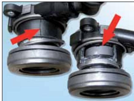
Kuva 5: Virheellisestä asennuksesta vioittunut hydr. painelaakeri
