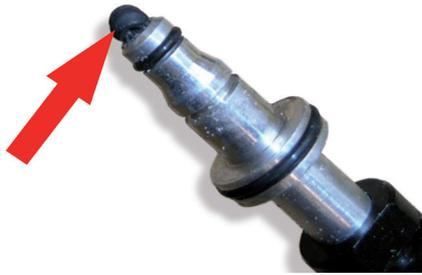
Figura 4: Se la vecchia guarnizione non viene rimossa, questa si sposterà in direzione del CSC bloccando il cavo
