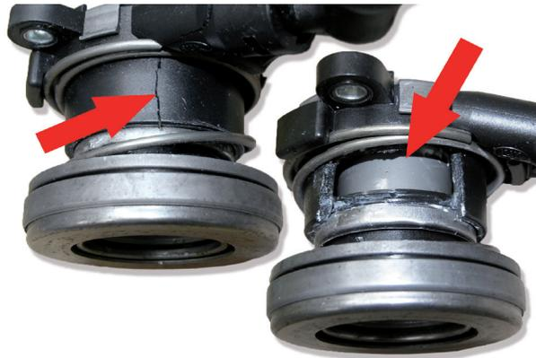
Figura 5: Attuatore concentrico rotto irrimediabilmente a causa di un montaggio errato
