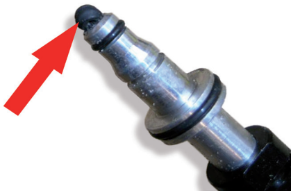
Afbeelding 4: Wordt de oude afdichtingsring niet weggenomen, dan wordt ze in de richting van het CSC gedrukt en verstopt de leiding.
