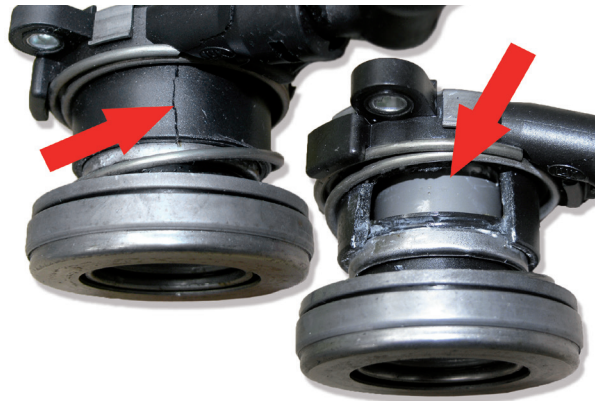
Afbeelding 5: Het CSC is beschadigd door foutieve montage.
