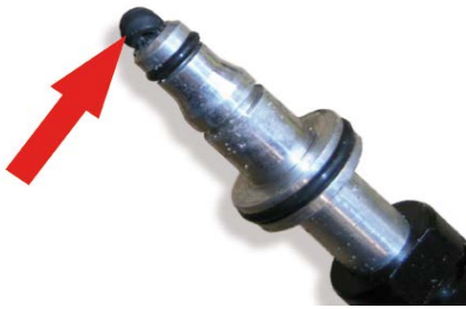
Bild 4: Om den gamla tätningsskivan inte tas bort, trycks den in i CSC och täpper till hydraulledningen
