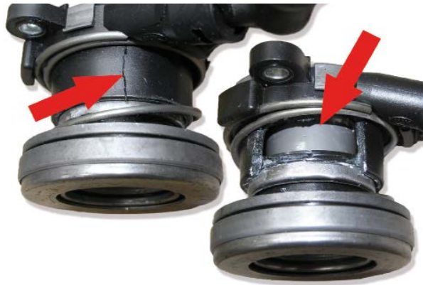
Bild 5: Slavcylindern förstörd genom felaktig montering
