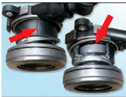
Рис 5: CSC поврежден из-за неправильной установки
