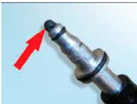
Рис 4: Если старый сальник не удален, он может быть выдавлен внутрь CSC, заблокировав трубку.
