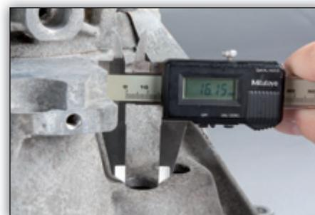
**Fig. 2:** Se o diâmetro for inferior a 21mm, os orifícios devem ser alargados com uma broca, até atingirem um mínimo de 21 mm e um máximo de 24 mm.
