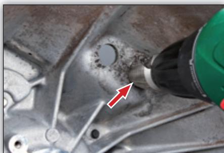
Fig. 5: Alargamento dos orifícios com uma broca.
