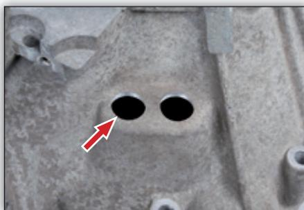
Fig. 6: Eliminação das rebarbas e limpeza.
