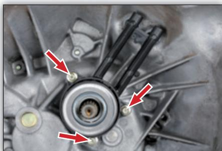
Fig. 7: Montagem do novo dispositivo central de desembraiagem.
