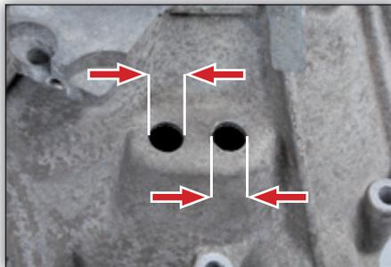
Fig. 4: Verificação do diâmetro.
