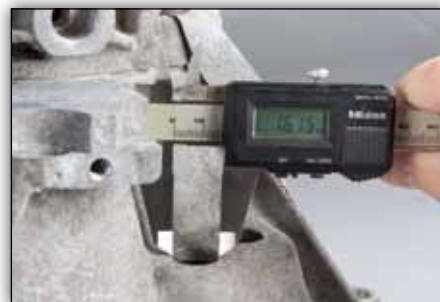
Fig.2: În cazul în care diametrul este mai mic de 21 mm, acesta trebuie mărit cel puțin la această dimensiune, dar nu mai mult de 24 mm
