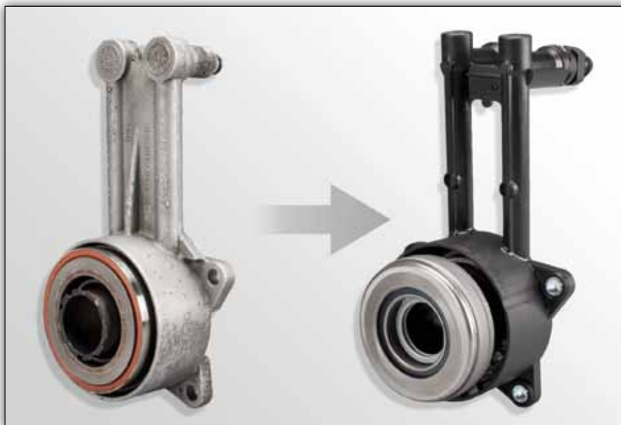
Fig. 1: Înlocuirea modelului din plastic cu unul metalic
