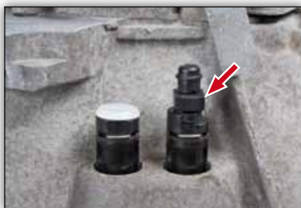
Fig. 8: Purjorul poate fi acționat cu mâna sau cu o cheie
