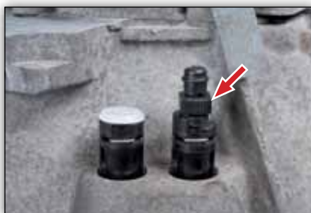
Obrázek 8: Odvzdušňovací nipl lze ovládat rukou popř. stranovým klíčem (13 mm)
