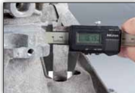
Obrázek 2: Pokud je průměr menší než 21 mm, musí se vyvrtat na min. 21 mm, max. 24 mm
