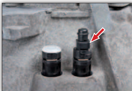
Figur 8: Udluftningsdyse kan styres manuelt eller med svensknøglen (13 mm)
