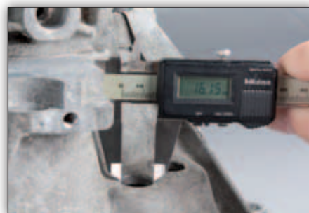
Figur 2: Er diameteren mindre end 21 mm, skal man bore den til min. 21 mm, maks. 24 mm
