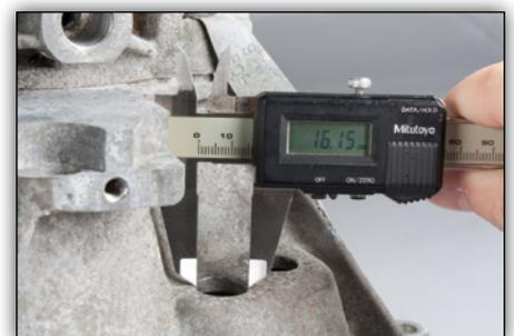
**Bild 2:** Ist der Durchmesser kleiner als 21 mm, muss auf mind. 21 mm, max. 24 mm aufgebohrt werden
