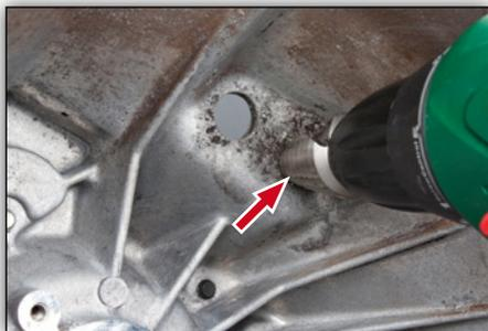
**Bild 5:** Löcher aufbohren
