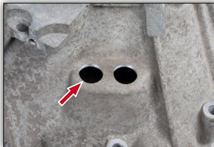
**Bild 6:** Entgraten und reinigen
