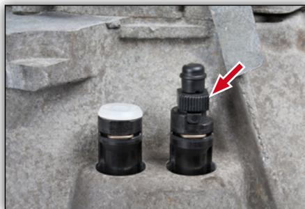
**Bild 8:** Der Entlüfternippel kann mit der Hand oder mit einem Maulschlüssel (SW 13) betätigt werden
