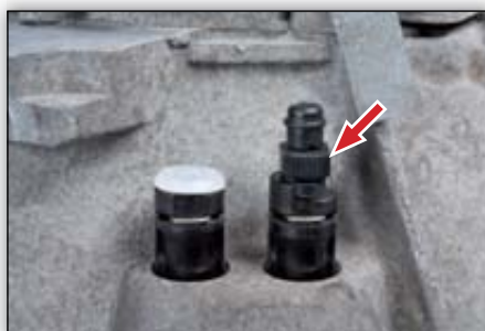
Εικόνα 8: Το ρακόρ εξαέρωσης μπορεί να ενεργοποιηθεί με το χέρι ή με ένα γερμανικό κλειδί (13 κιλ.)
