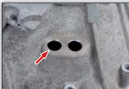
Εικόνα 6: Απομάκρυνση γρεζιών και καθαρισμός
