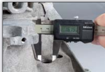
Εικόνα 2: Αν η διάμετρος είναι μικρότερη από 21 mm, πρέπει να αυξηθεί σε τουλάχιστον 21 και το πολύ 24 mm
