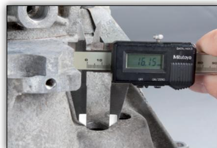
**Fig. 2:** Si el diámetro es menor de 21 mm, se deben ampliar los orificios con un taladro hasta que alcancen un mínimo de 21 mm y un máximo de 24 mm.
