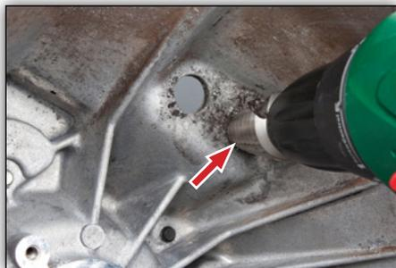
Fig. 5: Ampliación de los orificios con un taladro
