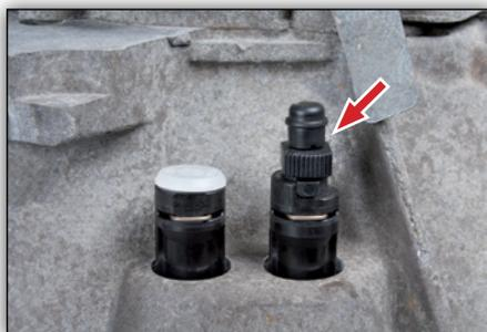
Fig. 8: Se puede accionar la boquilla de purga con la mano o con una llave de boca (ancho de llave: 13)
