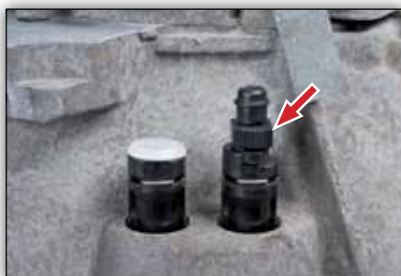
Kuva 8: Ilmausnippaa voi käyttää kädellä tai kiintoavaimella (13 mm)
