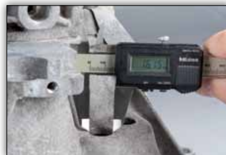
Kuva 2: Jos halkaisija on alle 21 mm, on se porattava vähintään 21 mm ja korkeintaan 24 mm kokoon
