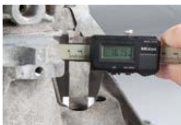
איור 2: במידה והקוטר קטן מ- 21 מ"מ, חובה להגדילו לפחות ל- 21 מ"מ עם הגבלת קוטר מקסימום של 24 מ"מ.
