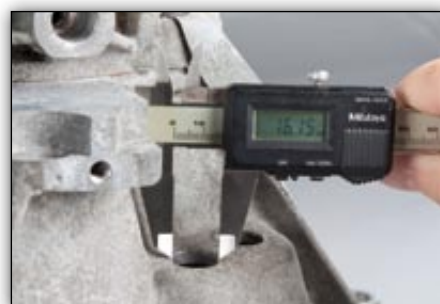
2. ábra: Ha az átmérő kisebb mint 21 mm, akkor azt legalább 21 mm-re, de max. 24 mm-re fel kell fúrni
