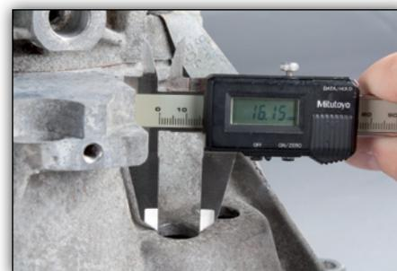
**Figura 2:** Se il diametro è inferiore a 21 mm, i fori devono essere ampliati da 21 mm fino ad un massimo di 24 mm
