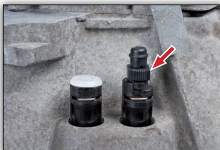
Figura 8: L'ugello di spurgo può essere azionato manualmente oppure con una chiave doppia da 13
