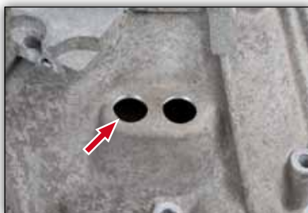
Bild 6: Borttagning av grader och rengöring
