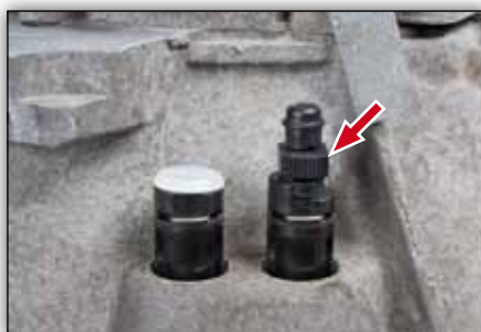
Bild 8: Avluftsningssnippeln kan manövreras för hand, ev. med skiftnyckel (13 mm)
