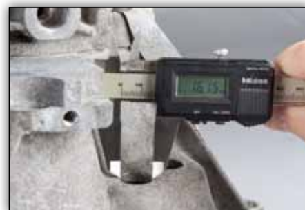
Bild 2: Om diametern är mindre än 21 mm, måste den borraras upp till minst 21 mm, max 24 mm
