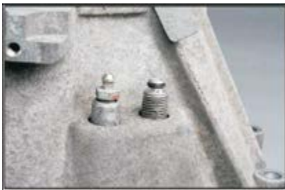
Рис. 3: Демонтаж подшипника старой конструкции
