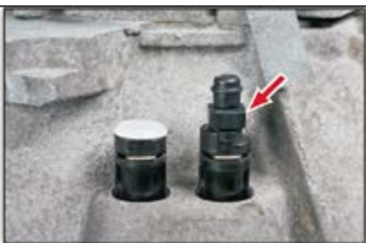
Рис. 8: Спускной патрубок можно подключить вручную или при помощи гаечного ключа (13 мм)
