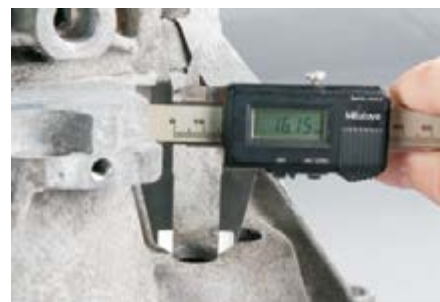
Рис 2: Если диаметр отверстий меньше 21 мм, то он должен быть увеличен по крайней мере до 21мм, максимум до 24мм.
