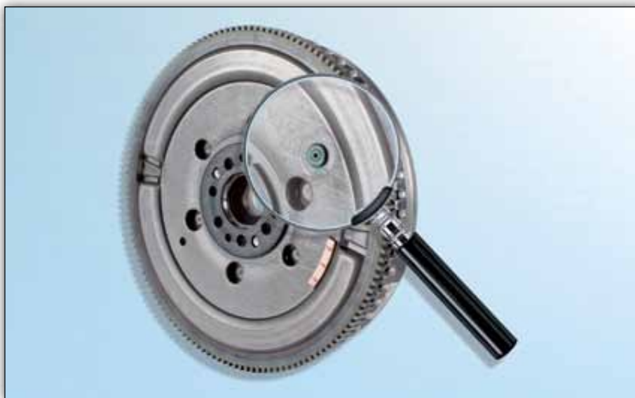
Obrázek 1: 415 0142 10 – transportní pojistka zůstává v dvuhmotovém setrvačníku
