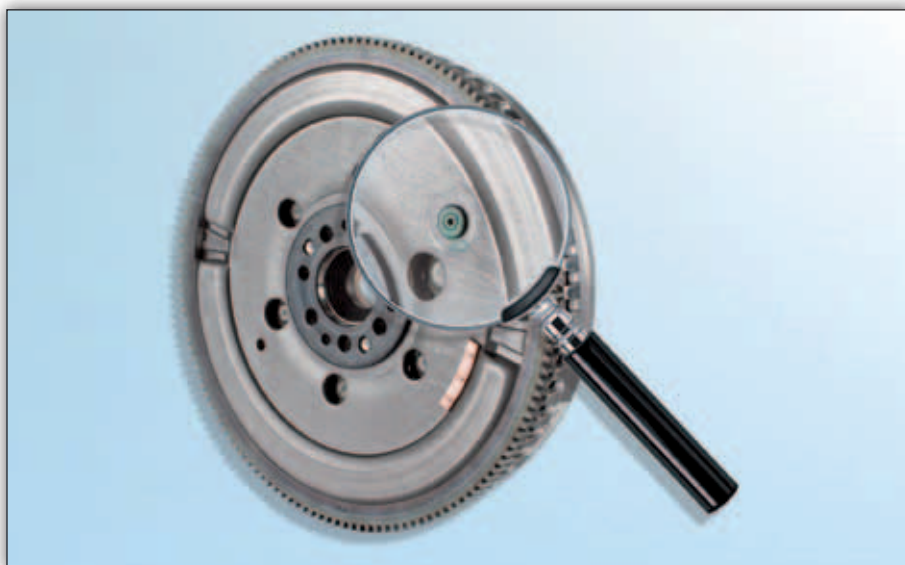
Figur 1: 415 0142 10 transportsikringen forbliver i dobbeltpladesvinghjulet
