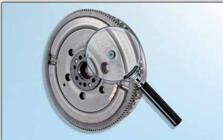
Kuva 1: 415 0142 10 – kuljetusvarmistin jää kaksoismassavauhtipyörään
