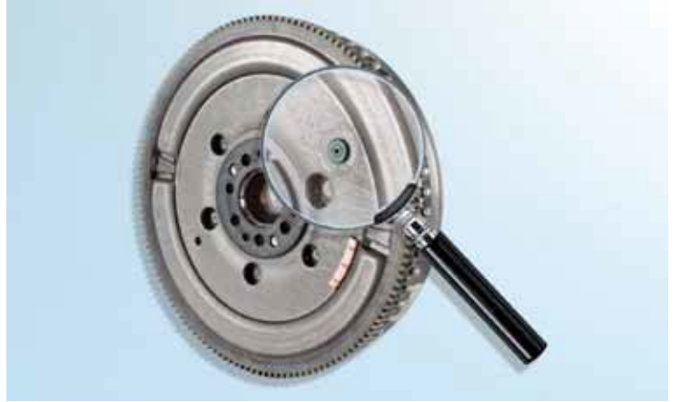
Şekil 1: DMF'de taşıma emniyet pimi motor ilk çalıştırıldığında iki parçaya ayrılır.
