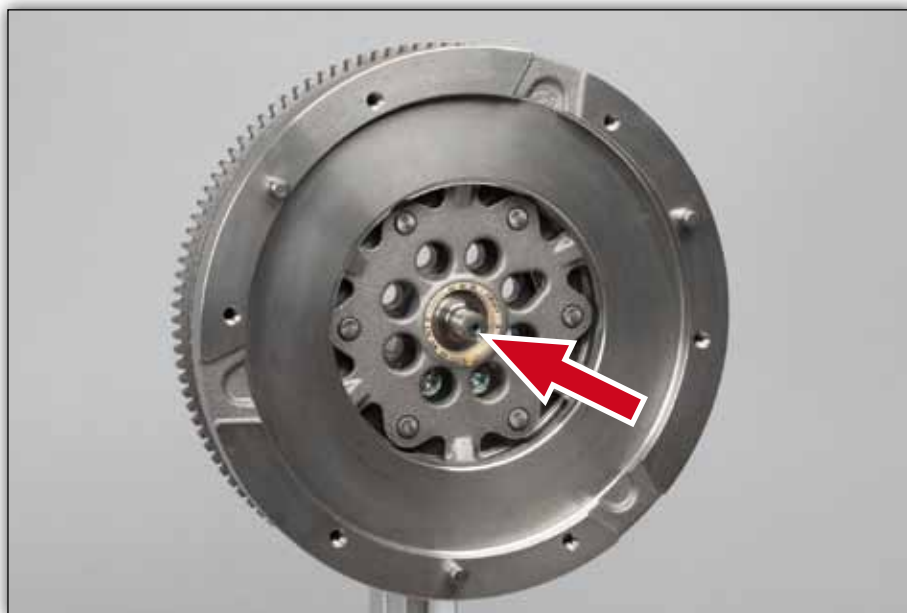
Fig. 1: Știft ghidare pe DMF 415 0377 10
