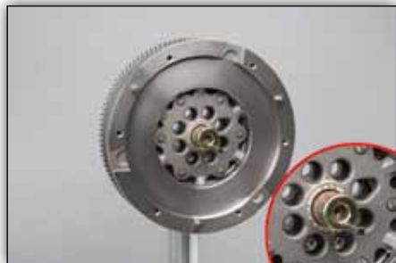
Fig. 4: Manșonul de ghidare se va monta înaintea ambreiajului (utilizați bulonul inclus în pachet)
