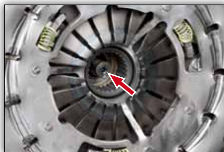
Fig. 2: 415 0377 10 prevăzut cu clemă atașată (SAC)
