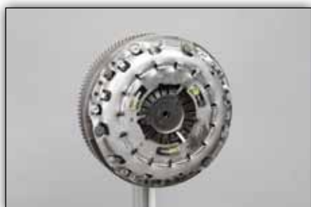
Fig. 7: Montați placa de presiune și strângeți șuruburile în mod egal și secvențial respectând forța indicată de producătorul auto
