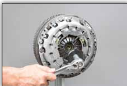
Fig. 8: Îndepărtați elementul blocant
