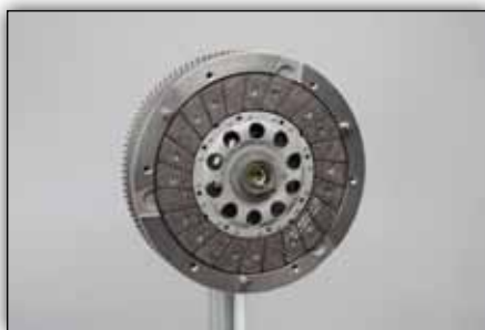
Снимка 5: Фиксирайте фрикционния диск на съединителя.
