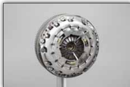
Снимка 9: Свалете центриращата втулка с помощта на болта.
