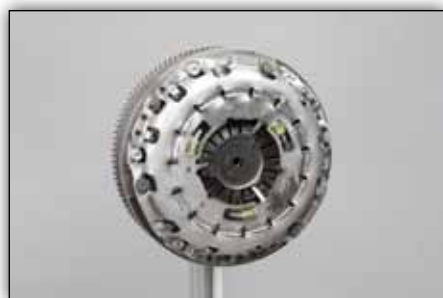
Снимка 7: Сложете притискателния диск на съединителя и затегнете равномерно и последователно болтовете до предписания от производителя на превозното средство въртящ момент на затягане.
