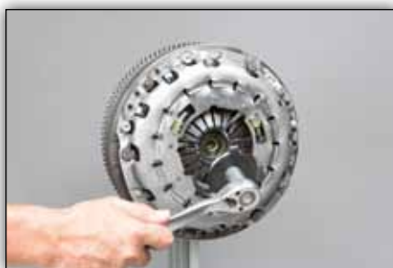
Снимка 8: Развийте блокиращия елемент с помощта на подходящ инструмент и го свалете. Той вече не е необходим.
