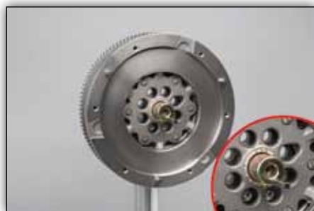
Снимка 4: Монтирайте центриращата втулка преди монтажа на съединителя (внимавайте за монтирания болт).
