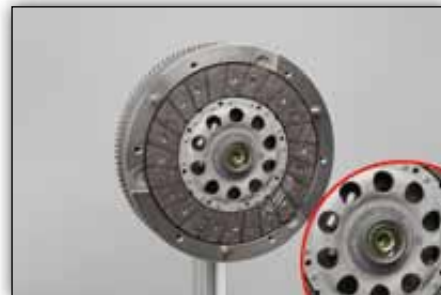
Obrázek 6: Vyšroubujete šroub ze středícího pouzdra
