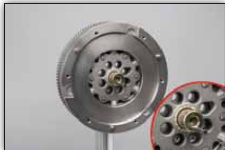
Obrázek 4: Před montáží spojky nasadíte středící pouzdro (věnujte pozornost správné orientaci závitové díry pro „vytahovací“ šroub)
