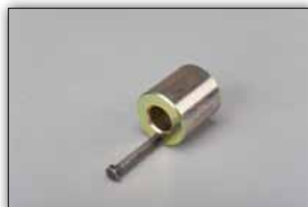
Obrázek 3: Středící pouzdro (400 0076 10) se použije u dvuhmotových setrvačnicků s vodicím čepem
