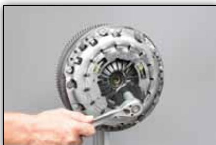
Obrázek 8: Vhodným nástrojem pootočte a vyjměte aretační přípravek. Již nebude potřebný
