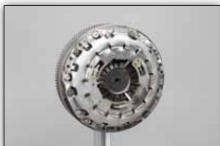
Obrázek 7: Nasadíte přitlačný kotouč spojky a šrouby dotáhněte výrobcem vozidla předepsaným utahovacím momentem
