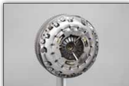
Obrázek 9: Pomocí vytahovacího šroubu vyjměte středící pouzdro
