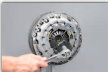
Figur 8: Brug et egnet værktøj til at dreje fastlåsningsanordningen og tage den ud. Den skal ikke bruges mere
