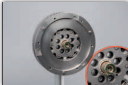
Figur 4: Inden koblingsmontering skal man sætte bøsningen på (pas på opstilling af "ekstruderings-skrue")
