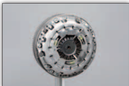
Figur 7: Koblingstrykpladen sættes på og skrue fastspændes med den af køretøjfabrikanten fastsat vridningsmoment.
