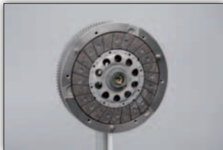
Figur 5: Koblingslamellen sættes på.
