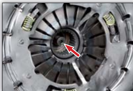
Εικόνα 2: 415 0377 10 με τοποθετημένο αυτορυθμιζόμενο συμπλέκτη (SAC)
