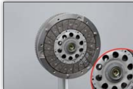
Εικόνα 6: Αφαιρέστε τη βίδα από το σωληνωτό πείρο κεντραρίσματος
