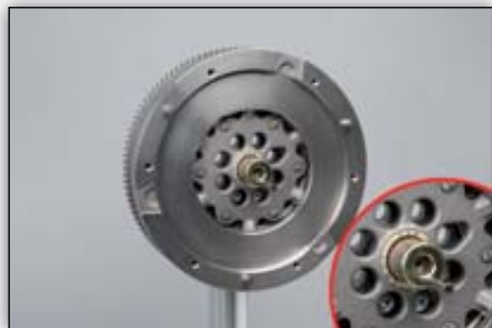
Εικόνα 4: Τοποθετήστε το σωληνωτό πείρο κεντραρίσματος πριν την τοποθέτηση του συμπλέκτη (προσοχή στην τοποθετημένη βίδα)
