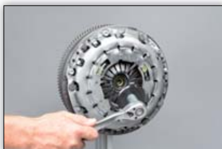
Εικόνα 8: Ξεβιδώστε και αφαιρέστε το στοιχείο ασφάλισης με το κατάλληλο εργαλείο.
