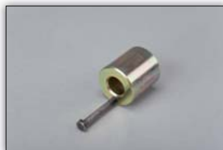
Εικόνα 3: Ο σωληνωτός πείρος κεντραρίσματος (400 0076 10) χρησιμοποιείται σε βολάν διπλής μάζας με πείρο-οδηγό.
