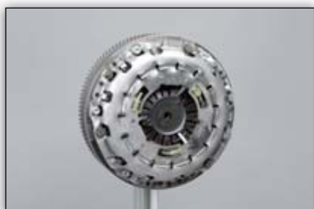
Εικόνα 7: Τοποθετήστε την πλάκα πίεσης και σφίξτε τις βίδες με την προκαθορισμένη από τον κατασκευαστή του οχήματος ροπή σύσφιγξης.
