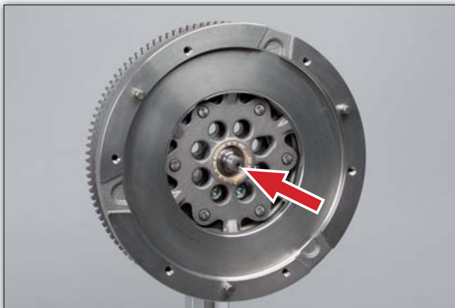
Εικόνα 1: Πείρος-οδηγός στο βολάν διπλής μάζας 415 0377 10
