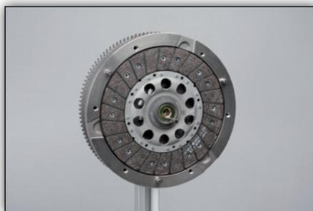
**Fig. 5:** Coloque el disco de embrague.
