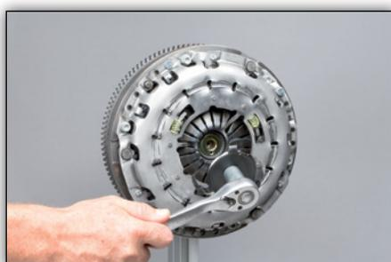
**Fig. 8:** Desenrosque y extraiga la pieza de bloqueo con la herramienta adecuada. En adelante, no será necesaria.
