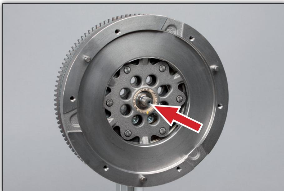
**Fig. 1:** Espiga de guía del volante bimasa 415 0377 10
