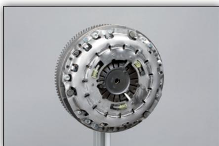
**Fig. 7:** Coloque el plato de presión del embrague y los tornillos, y apriete al par de apriete recomendado por el fabricante del vehículo.
