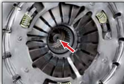
Kuva 2: 415 0377 10 kytkin asennettuna (SAC)
