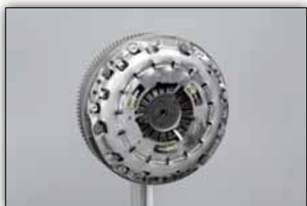
Kuva 7: Aseta kytkimen painelevy paikalleen ja kiristä ruuveilla ajoneuvon valmistajan esittämällä kiristysmomentilla
