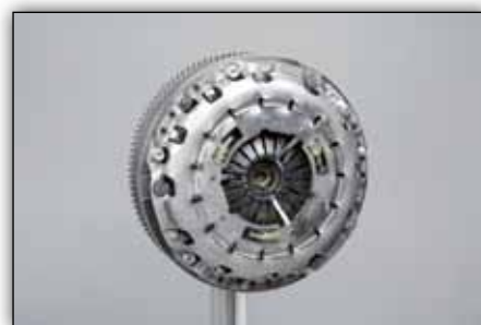
Kuva 9: Irrota keskitysholkki ulosvetoruvien avulla
