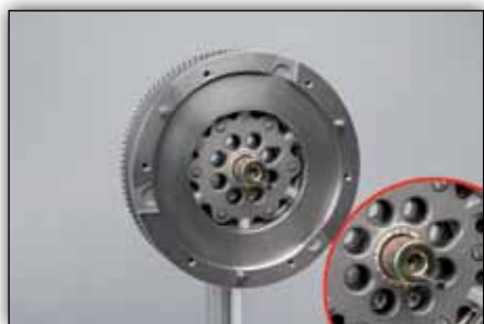
Kuva 4: Aseta keskitysholkki paikoilleen ennen kytkimen asennusta. (ruuvitappi holkin kärjessä)
