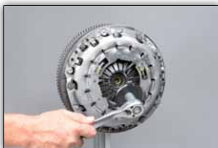
Kuva 8: Poista painelevyn lukitusholkki kääntämällä asianmukaisella työkalulla, sitä ei enää tarvita.
