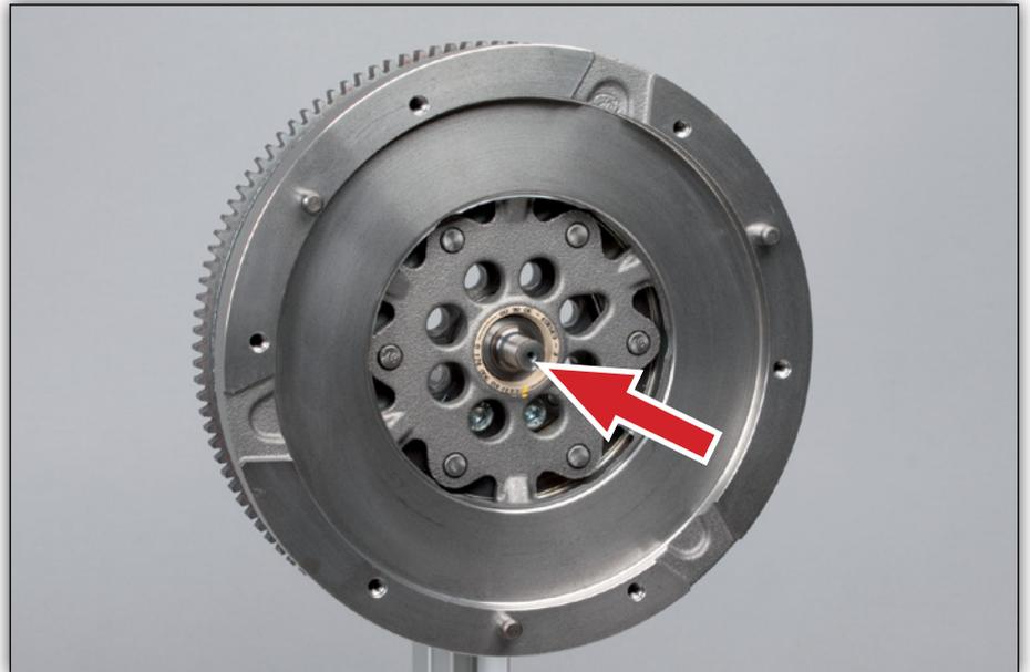
Image 1 : tenon-guide sur le volant bimasse 415 0377 10
