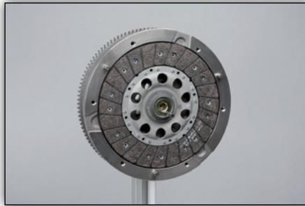
**Image 5 :** appliquer le disque d'embrayage
