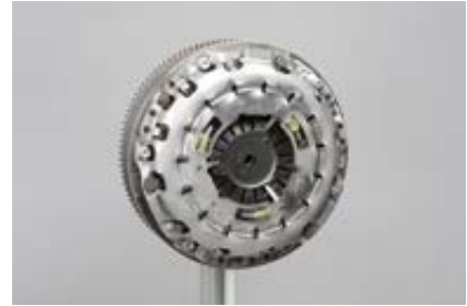
איור 7: התקן את פלטת הלחץ של המצמד ובצע הידוק ברגים בצורה שווה ומסודרת באמצעות מומנט ההידוק אשר מוזכר בנוהל העבודה של יצרן הרכב עליו אתה עובד.
