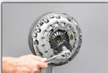
8. ábra: Egy alkalmas szerszámmal csavarja ki a reteszelőidomot és távolítsa el. Arra már nem lesz szükség
