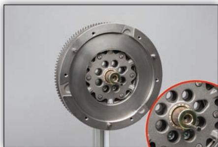
Fig. 4: Breng de centreerbus aan alvorens de koppeling te monteren (let op de aangebrachte bout)
