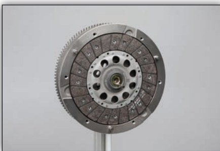
Fig. 5: Plaats de koppelingsschijf
