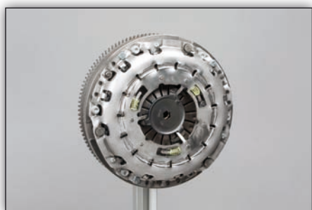
Fig. 7: Breng de koppelingsdrukplaat aan en haal de bouten aan met het door de autofabrikant voorgeschreven aanhaalmoment
