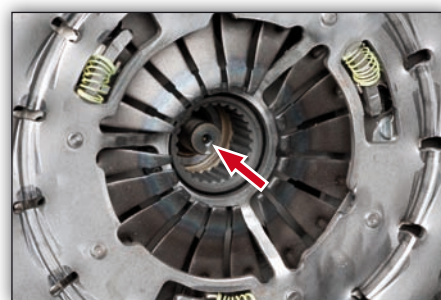
Fig. 2: 415 0377 10 met gemonteerde koppeling (SAC)
