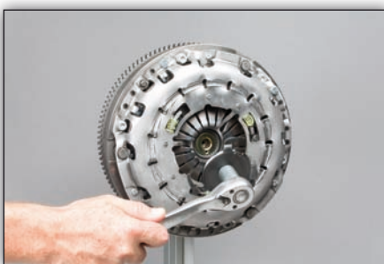
Fig. 8: Draai het vergrendelingsstuk met passend gereedschap eruit en verwijder het. U heeft dit niet meer nodig
