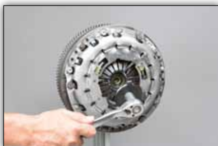
Slika 8: S primernim orodjem odvijte blokirni element in ga odstranite. Ne boste ga več potrebovali.
