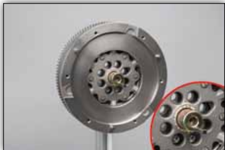
Slika 4: Centrirni tulec namestite pred montažo sklopke (pazite na montirani vijak).
