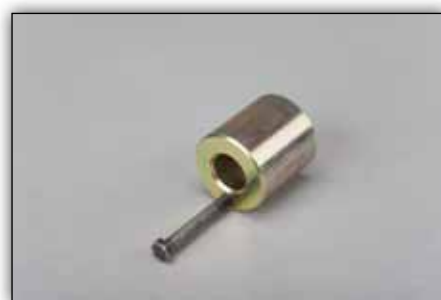
Slika 3: Centrirni tulec (400 0076 10) je treba pri dvomasnih vztrajnikih uporabiti z vodilnim zatičem.
