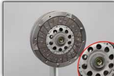
Slika 6: Odstranite vijak iz centrirnega tulca.
