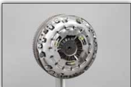
Slika 7: Namestite tlačno ploščo sklopke in pritegnite vijake s priteznim momentom, ki ga predpisuje proizvajalec vozila.
