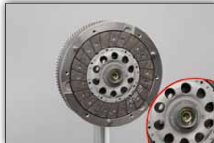
Bild 6: Skruva loss skruven från centreringsbussningen
