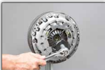
Bild 8: Vrid och ta bort blockeringsvertyget med lämpligt verktyg. Detta kommer inte att behövas mer
