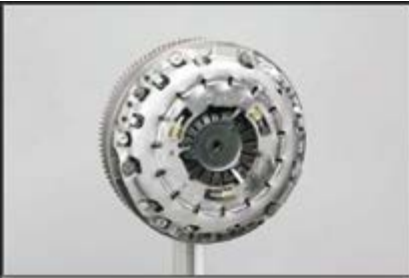
Рис 7: Установите нажимной диск сцепления и равномерно закрутите винты моментом, установленным автопроизводителем.
