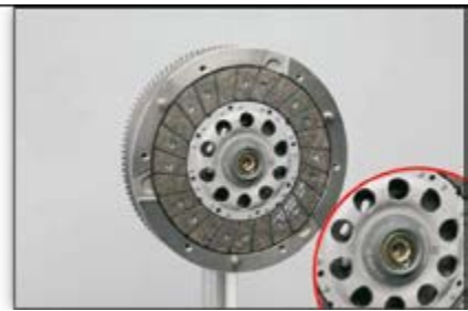
Рис 6: Открутите винт с центрирующей втулки.
