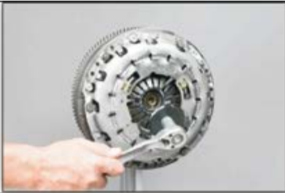
Рис 8: Открутите фиксирующий элемент специальным инструментом и снимите. Он больше не потребуется.
