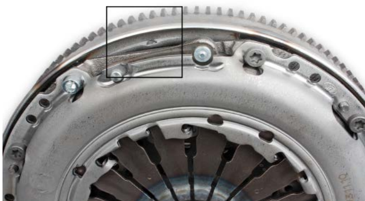
Obrázek 1: Úbytek materiálu při použití příliš dlouhých šroubů
