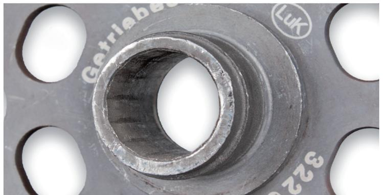
Bild 2: Beschädigtes Nabenprofil
