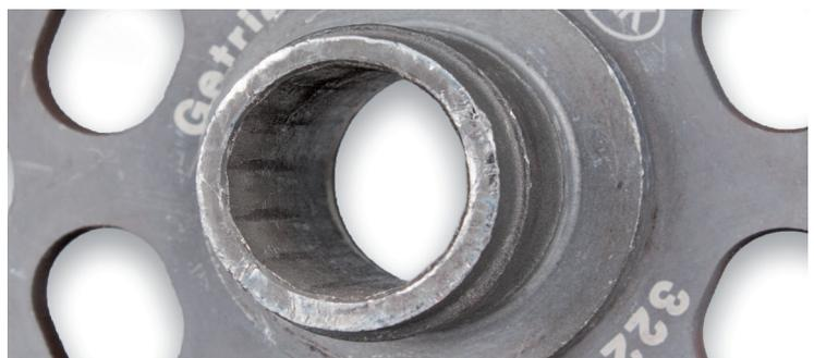
Fig. 2: Perfil del buje dañado
