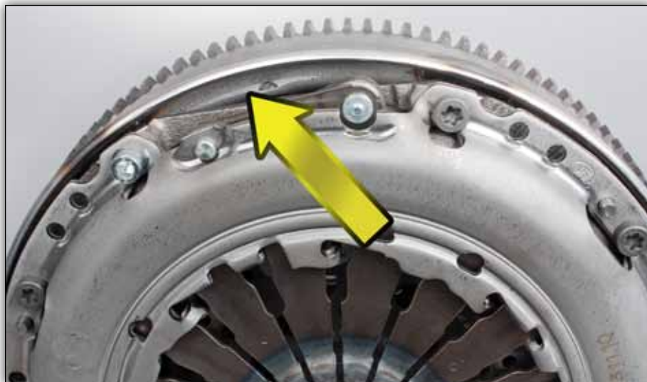
Kuva 1: Materiaalin hankautuminen käytettäessä liian pitkiä ruuvia
