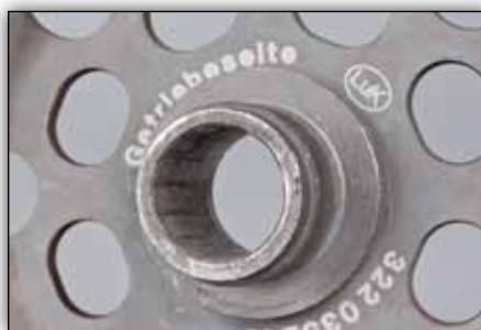
Kuva 2: navan vahingoittunut profilli
