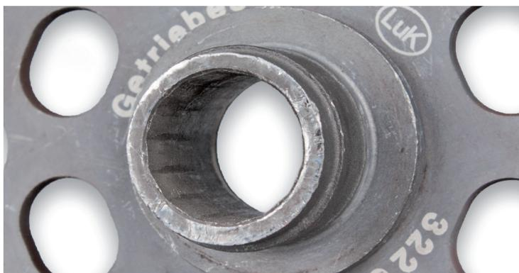
Figura 2: Dentatura del mozzo danneggiata
