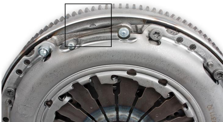
Рисунок 1: Деталь повреждена из-за применения слишком блинных болтов.
