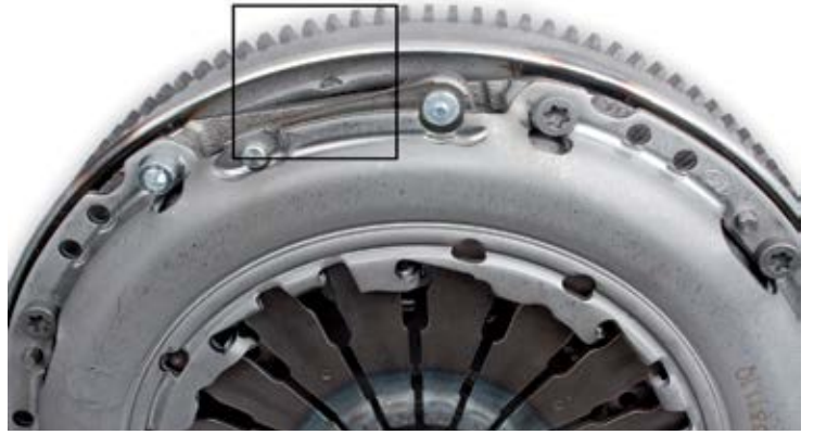
Resim 1: Çok uzun cıvata kullanımından meydana gelen materyal aşınması
