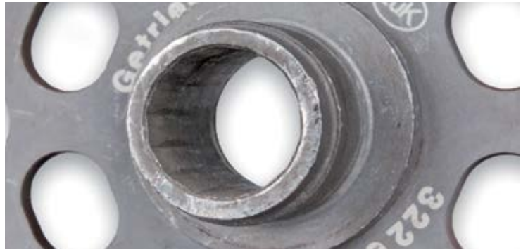
Resim 2: Hasar görmüş freze profili
