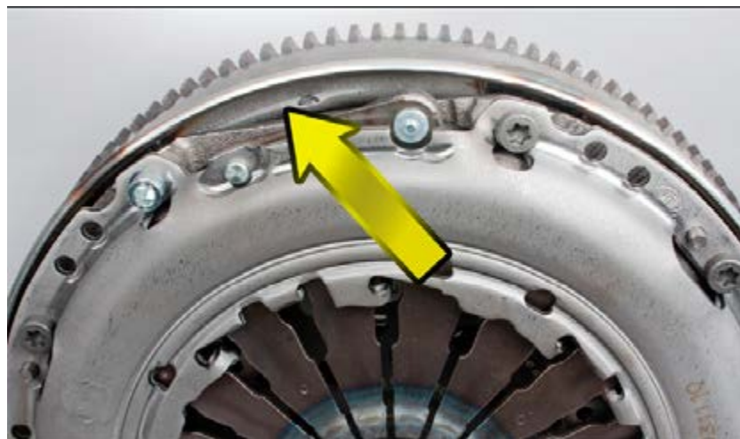
Рис. 1: Износ из-за слишком длинных болтов
