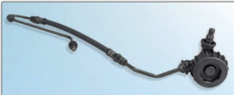
Figur 1: Hydrauliske føringer med frekvensmodulator (vibrationsfilter)
