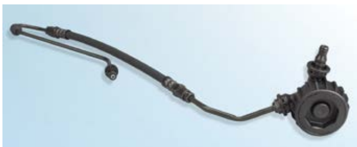
איור 1: הידראולי עם יחידת אפנון תדר, (יחידת מניעת רעידות - anti vibration unit)
