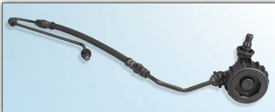
1. ábra: Hidraulikavezeték frekvenciamodulátorral (csillapító-szűrő)
