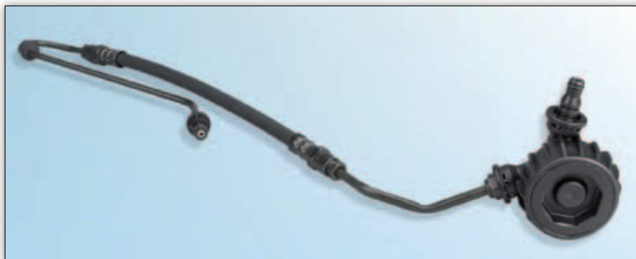
Bild 1: Hydraulledning med frekvensmodulator (antivibrationsfilter)
