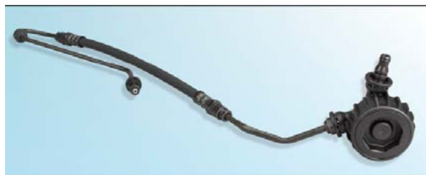
Рис. 1: Гидравлическая магистраль с частотным модулятором (антивибрационный модуль)
