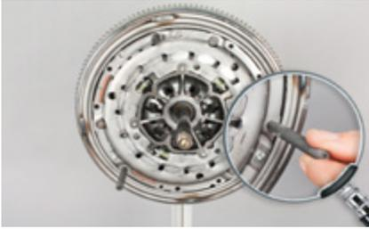
Fig. 5: Aparafusar manualmente o espigão da ferramenta SAC até encontrar uma primeira resistência. Não utilizar nenhuma ferramenta.
