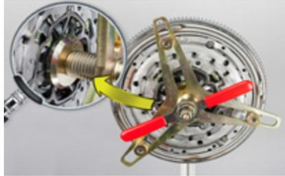
Fig. 6: Montar a ferramenta SAC e pressionar o diafragma até que o prato de pressão fique completamente apoiado no volante bimassa.
