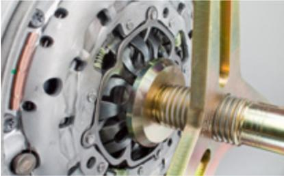
Fig. 8: Tirar a pressão do diafragma afrouxando o fuso da ferramenta SAC e retirá-la do veículo.
