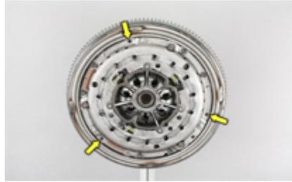
Fig. 9: Aparafusar manualmente os 3 parafusos restantes e apertá-los a  $10,5 \pm 1$  Nm
